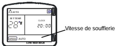
La vitesse de soufflerie peut être sélectionnée en appuyant sur le bouton « FAN SPEED ».
