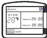
Utiliser les deux fonctions pour programmer l'appareil pour qu'il démarre et qu'il s'arrête à des heures définies.
