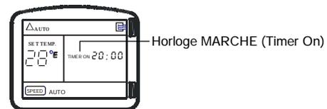
Cette fonction permet de faire démarrer l'appareil automatiquement après un certain nombre d'heures. La fonction « TIMER ON » peut être définie lorsque l'appareil est à l'arrêt.
